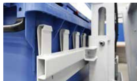
Bezpieczne mocowanie pojemników na odpady
